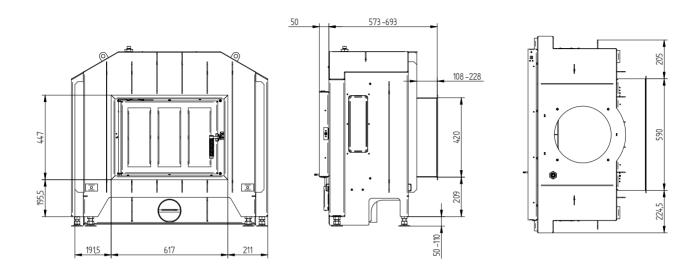
HAKA 89/45 Allumage par l'extérieur échangeur de chaleur en acier verticalement / raccordement cheminée 45°
